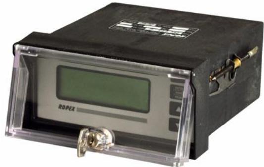
Als zusätzlichen Schutz können die CIRUS- und RESISTRON-Temperaturregler zum Fronttafeleinbau (Gehäuseabmessungen B x H: 144 x 72mm) mit diesen Vollsichttüren ausgestattet werden. Hierzu steht eine Standardversion mit Verriegelungsknopf (TUER-K-1) und eine abschließbare Version mit Schlüssel (TUER-S-1) zur Verfügung.
